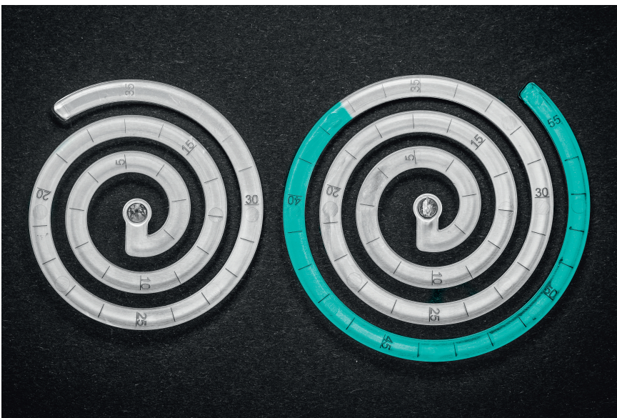
Bild 1. Vergleich von PMMA (links) und einem Blend aus PMMA und 10 % bFI A 3745 (rechts) in Fließspiralen: Der eingefärbte Bereich zeigt, dass das Blend eine deutlich weitere Strecke zurücklegt. © Polytives
